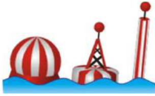
Aguas navegables (aguas seguras)
